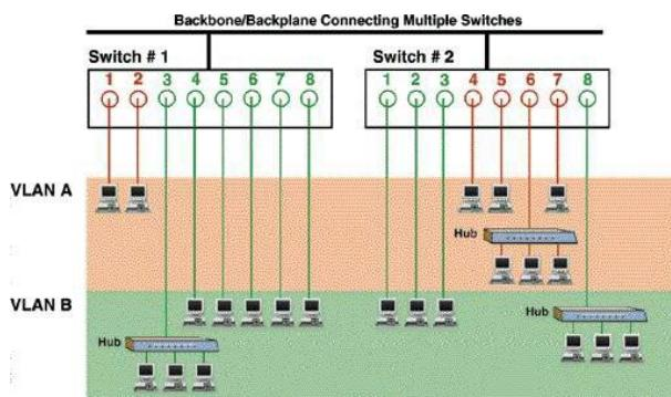
VLAN de manera automática basándose en información tal como la dirección MAC del dispositivo que se conecta al puerto o el nombre de usuario utilizado para acceder al dispositivo. En este procedimiento, el dispositivo que accede a la red, hace una consulta a la base de datos de miembros de la VLAN. Se puede consultar el software FreeNAC para ver un ejemplo de implementación de un servidor VMPS.
