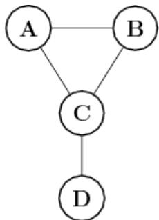
Inicialmente A y B tienen ambos una distancia a D de 2 saltos. Supongamos que D se cae y nuevamente consideremos el gong gigante que determina periódicamente intercambios simultáneos. Usando “Split horizon”, ni A ni B intercambian (D,2) con C. Así, C determina que la distancia a D es de infinitos Saltos y reporta esto a A y B. Pero A ve que B tiene una distancia de 2 saltos a D y B ve que A tiene una distancia de 2 saltos a D, ambos
