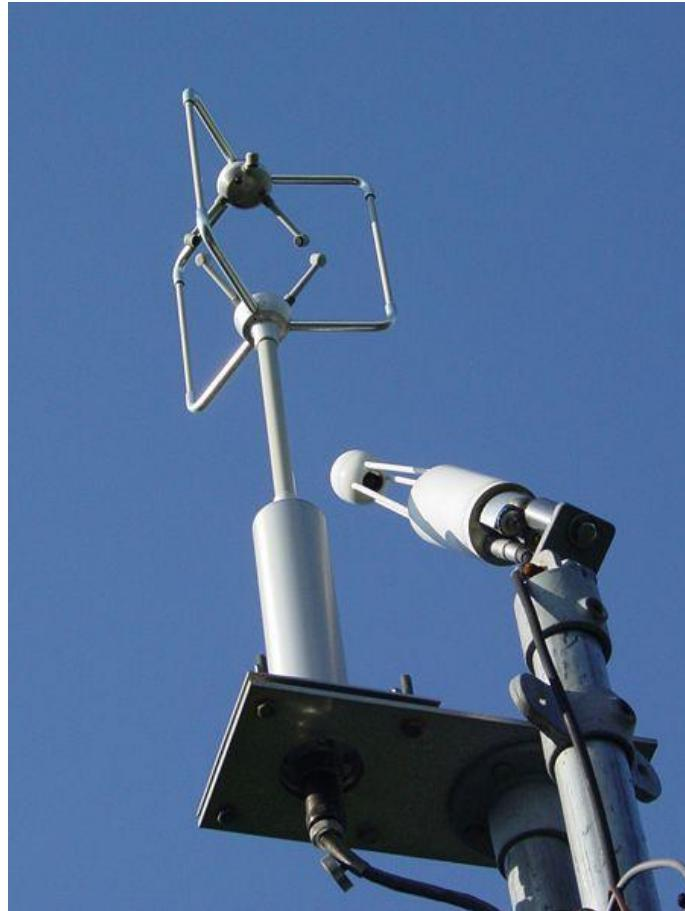
El sistema de eddy covarianza consiste en un anemómetro sónico y un analizador de gases infrarojo (IRGA)
